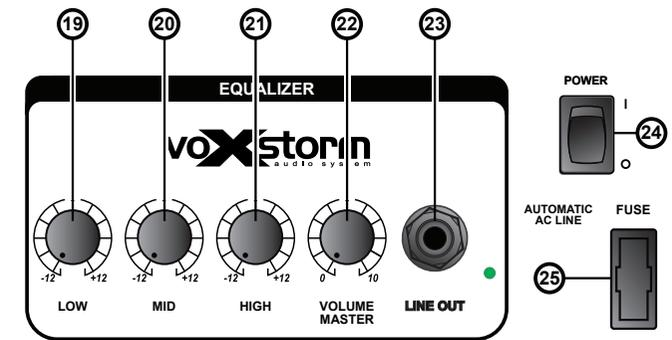
25- FUSE: Contém o fusível de proteção da entrada da rede elétrica. Em caso de queima, substitua-o por outro do mesmo tipo e valor.
